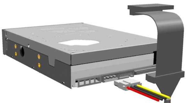
Figura 6: conexión de los cables al lector
