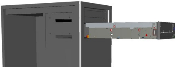
Figura 5: instalación del lector interno
